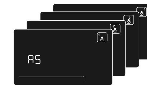
**Многопрофильность.** Автоматическая система пневматической системы, предпочтительные рабочие положения и настройки для каждого инструмента можно сохранять для 4 разных пользователей. Эта функция полезна в кабинетах с несколькими стоматологами.
