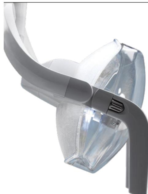
**Встроенный потенциометр.** Включенный в стандартную поставку галогеновый светильник Venus Plus имеет функцию мягкого запуска и цветовую температуру 4900K. Диапазон цветовой интенсивности: 8000 - 35 000 люкс, настраивается потенциометром.
