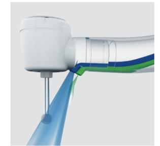
**O.D.R.** Стандартный механизм, который автоматически выпускает струю воздуха для удаления любых остаточных жидкостей или твердых веществ из наконечника после использования.
